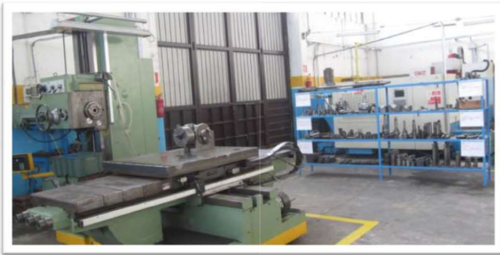
Alesatrice PAMA con n°4 assi visualizzati e testa birotativa
